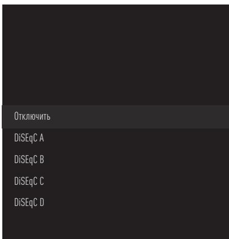
Выберите «DiSEqC A», «DiSEqC B», «DiSEqC C» или «DiSEqC D», чтобы выбрать спутник в соответствии с положением DiSEqC в спутниковой системе.
