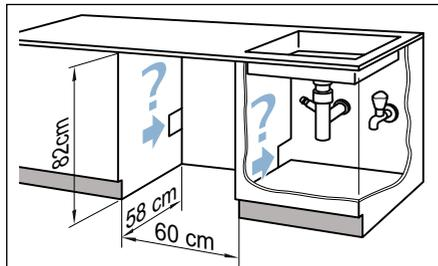
3. Проложите шланги и сетевой кабель. Задвигайте прибор, закрепляя при этом шланги и сетевой кабель.
