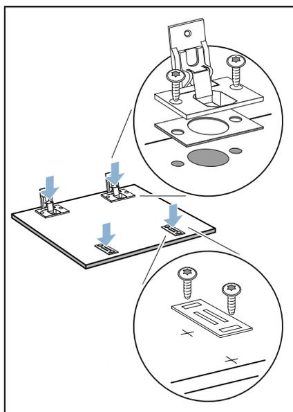
8. Просверлите отверстия. Для просверливания отверстия  $\varnothing 35$  мм используйте сверло с цилиндрической головкой.
