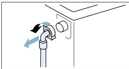
4. Для стандартных моделей и моделей с системой «Aqua-Secure» очистите сетчатый фильтр на задней стенке прибора:
