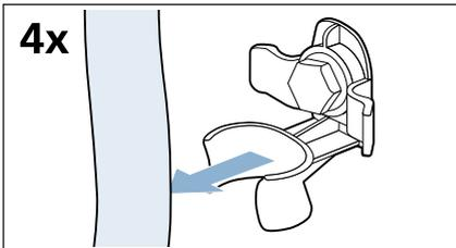
2. Выверните и снимите все 4 винта транспортировочных креплений при помощи гаечного ключа SW13.
