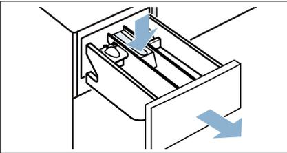
3. Сдвиньте дозатор вперёд, опустите и зафиксируйте.
