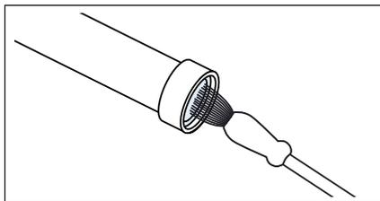
3. Для стандартных моделей и моделей с системой «Aqua-Secure» очистите сетчатый фильтр на задней стенке прибора:
