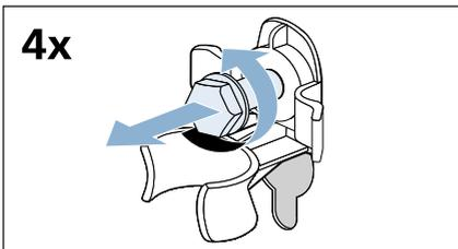
3. Снимите втулки. При этом извлеките сетевую кабель из держателей.
