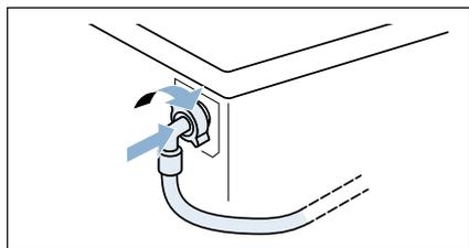
**Указание:** Осторожно откройте водопроводный кран и проверьте герметичность в местах соединений. Резьбовые соединения находятся под давлением воды.
