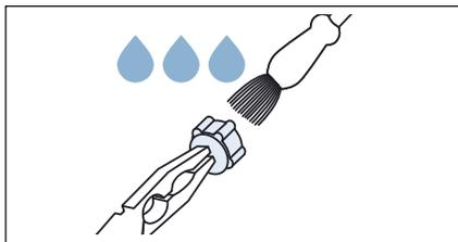
5. Подсоедините шланг и проверьте герметичность соединения.
