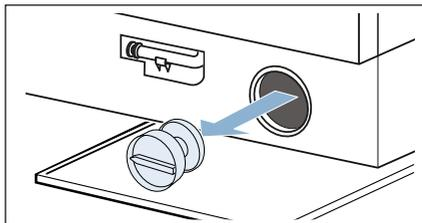
9. Очистите внутреннюю поверхность, резьбу крышки насоса и корпус насоса. Лопастное колесо откачивающего насоса должно свободно вращаться.
