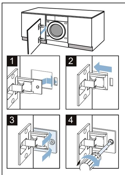
**11.** Установите магнитные защёлки на приборе.
