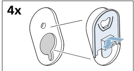
5. Плотно прижмите заглушки сверху и одновременно сдвигайте их вниз, пока крючки не зафиксируются со слышимым щелчком.
