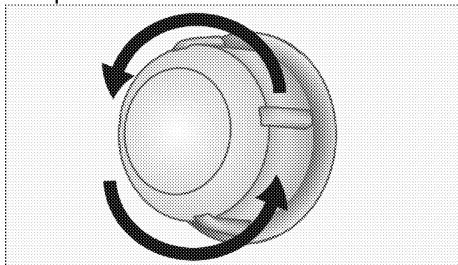
3. Если в вашей духовке используется лампа типа (A), показанная на рисунке ниже, поверните ее в соответствии с рисунком, чтобы извлечь ее и заменить. Если используется лампа типа (B), потянните и извлеките ее, как показано на рисунке, и замените.
